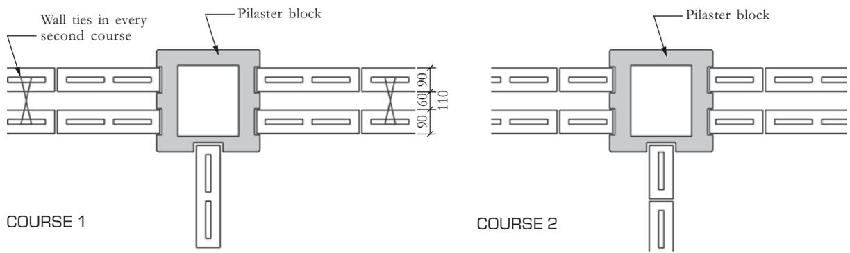
**PILASTER BLOCK FOR THREE WALLS**
