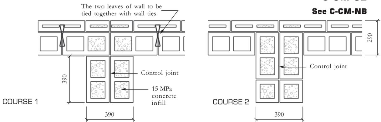
**390mm WIDE PIER 390mm PROJECTION – 290mm HOLLOW BLOCK SOLID WALL WITH CONTROL JOINT**
