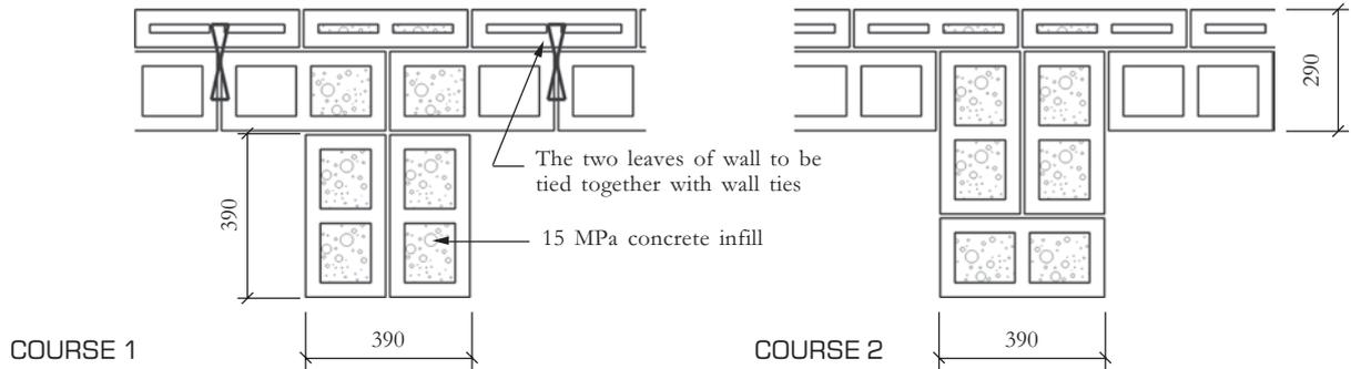
**390mm WIDE PIER 390mm PROJECTION – 290mm HOLLOW BLOCK SOLID WALL**
