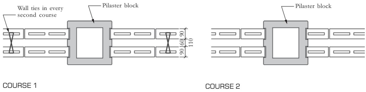
**PILASTER BLOCK FOR TWO WALLS**
