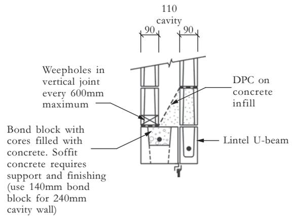
**LINTEL USING 190mm BOND BLOCK BEAM**
